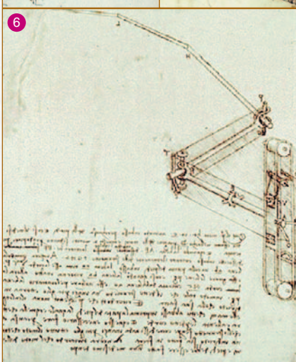
4. Крыло, которое, по расчетам Леонардо, при быстром давлении на рычаг могло взмахом поднять с земли свою тяжелую подставку. 5. Испытательные механизмы, воспроизводящие движения птичьего крыла. 6. Схема приспособления, копирующего крыло летучей мыши.
