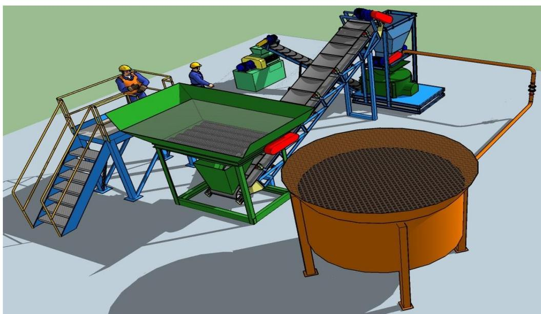
Гранулированная, капсулированная, таблетированная продукция из донных илов и органики водоемов производится на оборудовании 4 типоразмеров. Оно изготавливается с учетом свойств и характеристик сырья, требований к конечному продукту, его фасовке и упаковке. Производительность комплекса колеблется от 1 до 16 т/смену.
