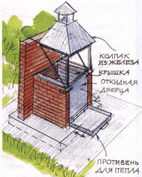
Рис. 4. Мусоросжигательная печь с кирпичными стенками. Для загрузки топлива предназначена откидная металлическая дверца.
