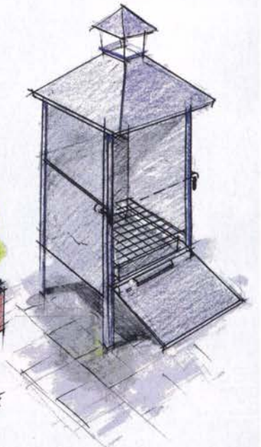
Рис. 6. Коробка-зольник выдвигается при открытой дверке топливника. Колпак-дымосборник из кровельного железа.
