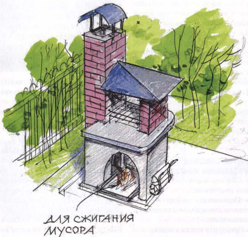
Рис. 1. Универсальная садовая печь помимо топки для сжигания мусора имеет мангал для приготовления шашлыков.
