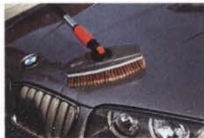
При мытье автомобиля щеткой велика вероятность поцарапать лакокрасочное покрытие.
