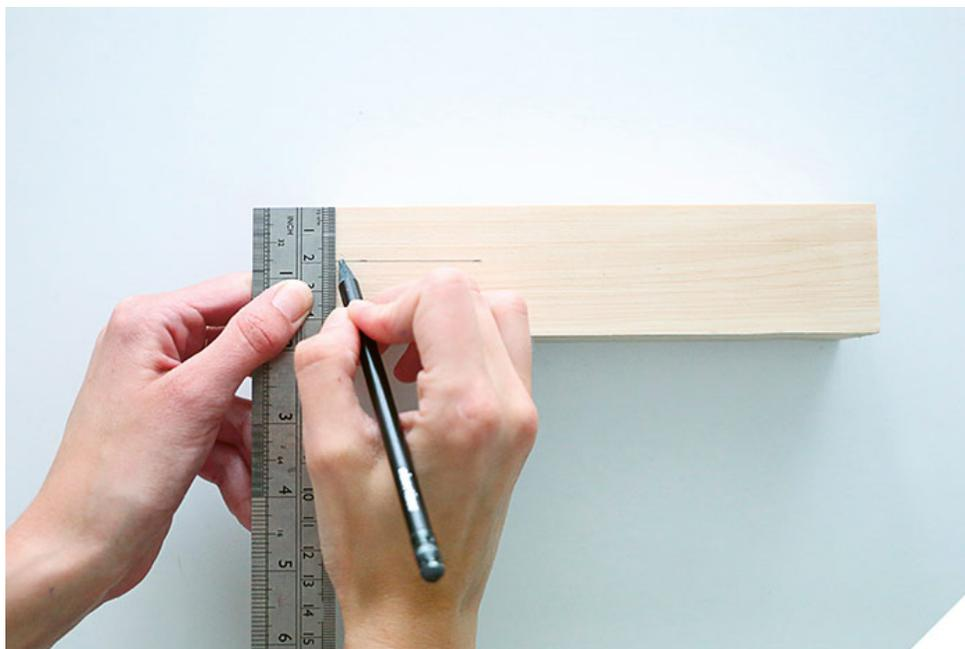
**2** Placez le bord de référence à gauche et faites pivoter le tasseau du côté adjacent aux 3 lignes tracées. Tracez une ligne de 6 cm à partir du bord gauche, à 2 cm du haut. Faites de même sur le côté opposé du tasseau.
