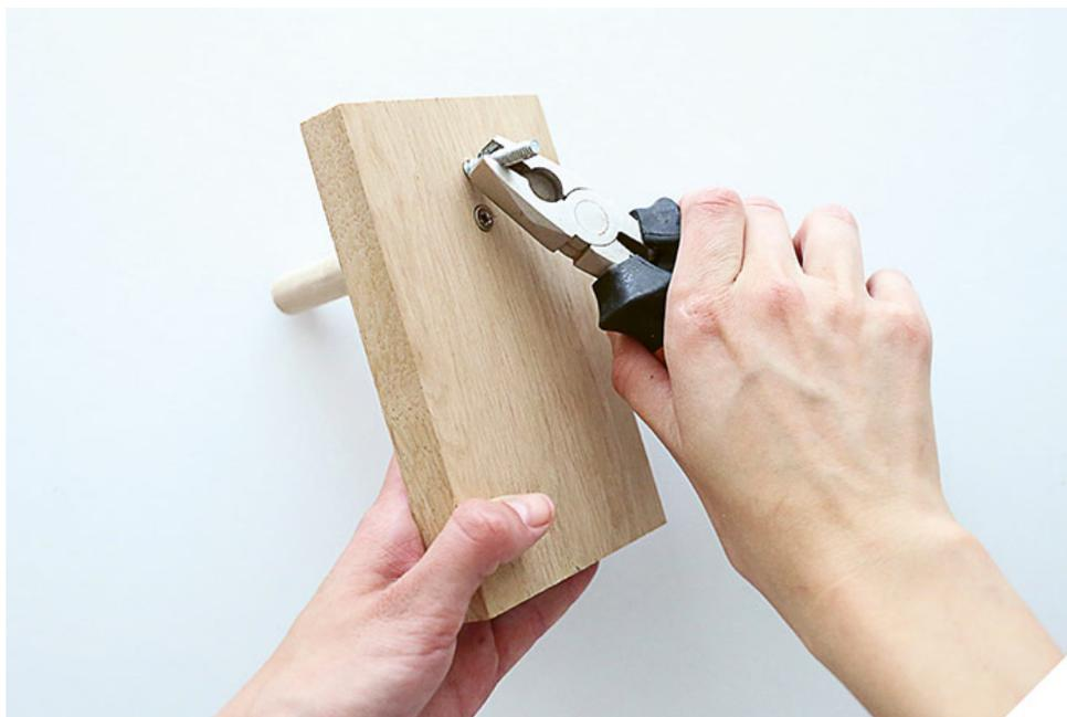
**12** Insérez la vis à double filetage dans le trou n° 1 à l'aide de la pince. Pour fixer la patère au mur, choisissez une cheville adaptée au mur et au diamètre de la vis à double filetage, puis vissez celle-ci.
