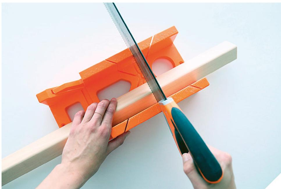
**1** Faites un repère au crayon sur la baguette d'angle, à 60 cm d'une extrémité. Sciez la baguette sur le repère dans la boîte à onglet.
