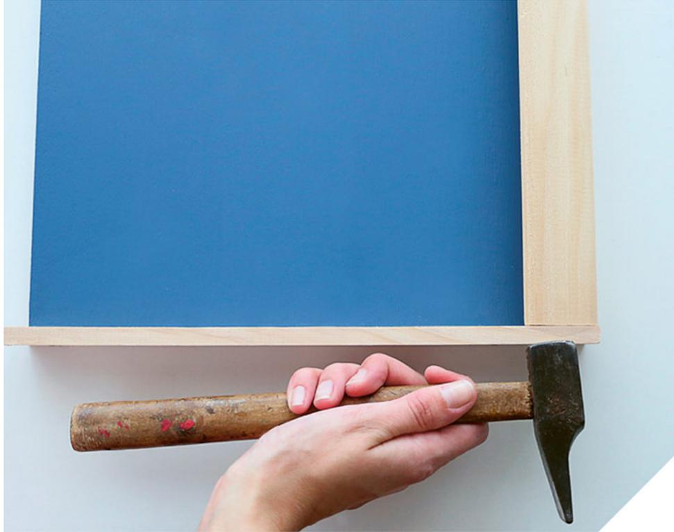
**5** Collez et clouez de la même façon un tasseau plat sur chaque petit côté de la planche. Puis ajoutez des clous au niveau des extrémités des baguettes.
