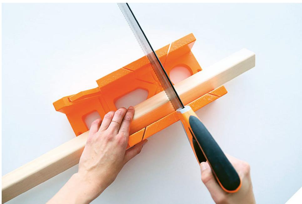
Faites un repère au crayon sur votre morceau de bois pour marquer où le couper. Placez-le dans la boîte à onglet, en plaçant bien le repère tracé au niveau de l'encoche pour la scie et sciez-le.
