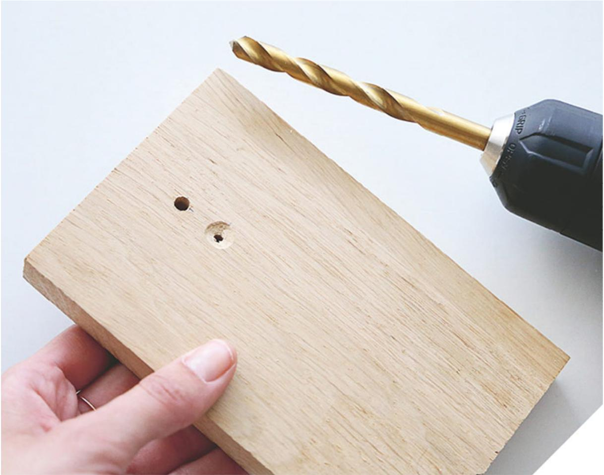
Une fois le trou percé, il reste une dernière étape à réaliser avant de visser, c'est le fraisage du trou. Les vis peuvent avoir plusieurs sortes de tête, dont la plupart sont proéminentes. Afin que leur tête ne dépasse pas de la planche en bois, il faut donc fraiser le trou avec une mèche de même diamètre que celui de la tête de vis. Dans ce cas, une astuce consiste à faire tourner la mèche dans le sens inverse de la marche pour seulement créer un renforcement.
