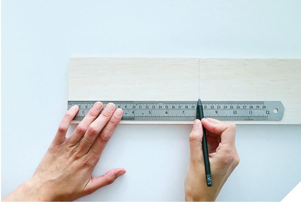
**1** Mesurez et tracez une ligne verticale sur la planche de balsa, à 20 cm du bord.
