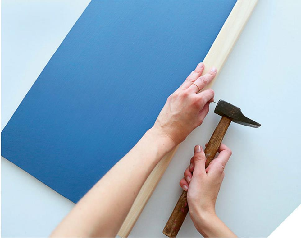
4 Collez le bord de la baguette sur la tranche de la planche. Essuyez le surplus de colle. Renforcez le collage avec 3 clous à 0,5 cm du bord de la baguette : un milieu de la longueur et 2 autres à 15 cm à gauche et à droite du 1<sup>er</sup>.
