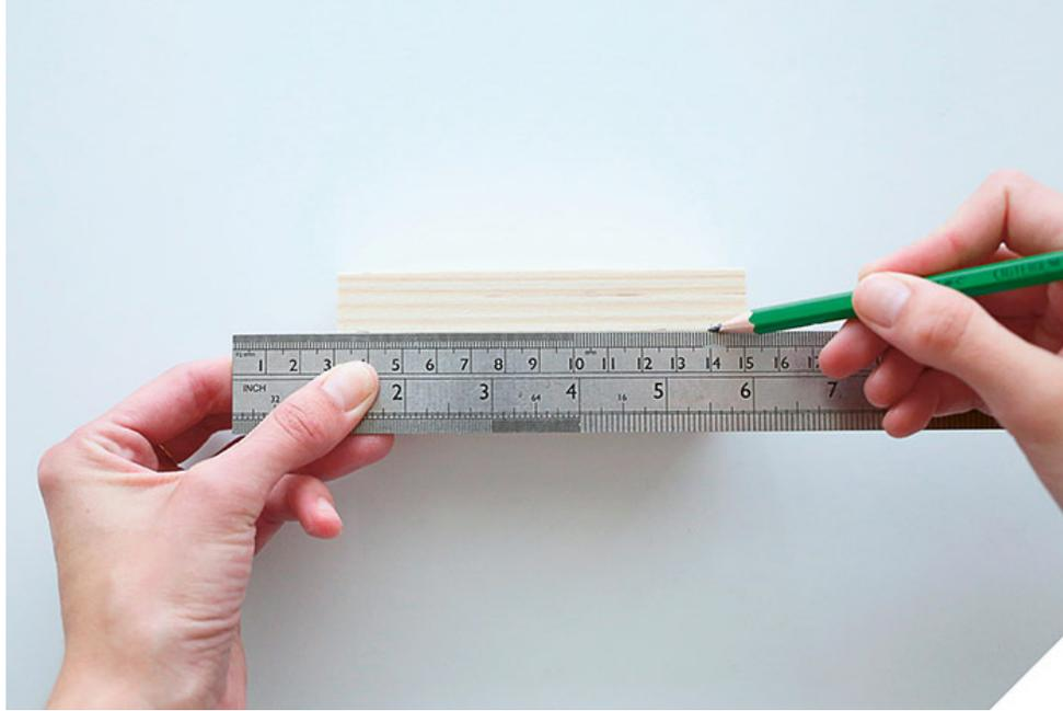
1 Tracez une ligne au crayon au milieu de la largeur du tasseau (soit à 1,85 cm d'un bord), sur toute sa longueur.
