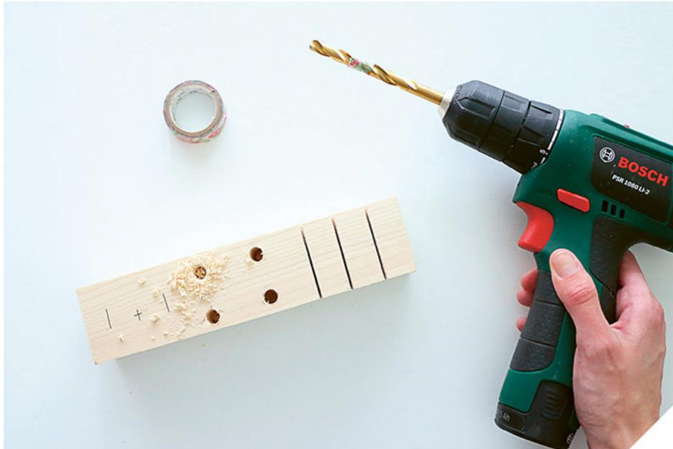
4 Fixez de l'adhésif à 3 cm de l'extrémité de la mèche de 8 mm. Percez des trous de 3 cm de profondeur sur les 4 points de repère. Puis placez la pointe de la mèche plate sur le dernier repère et percez un trou de 1,5 cm de profondeur.
