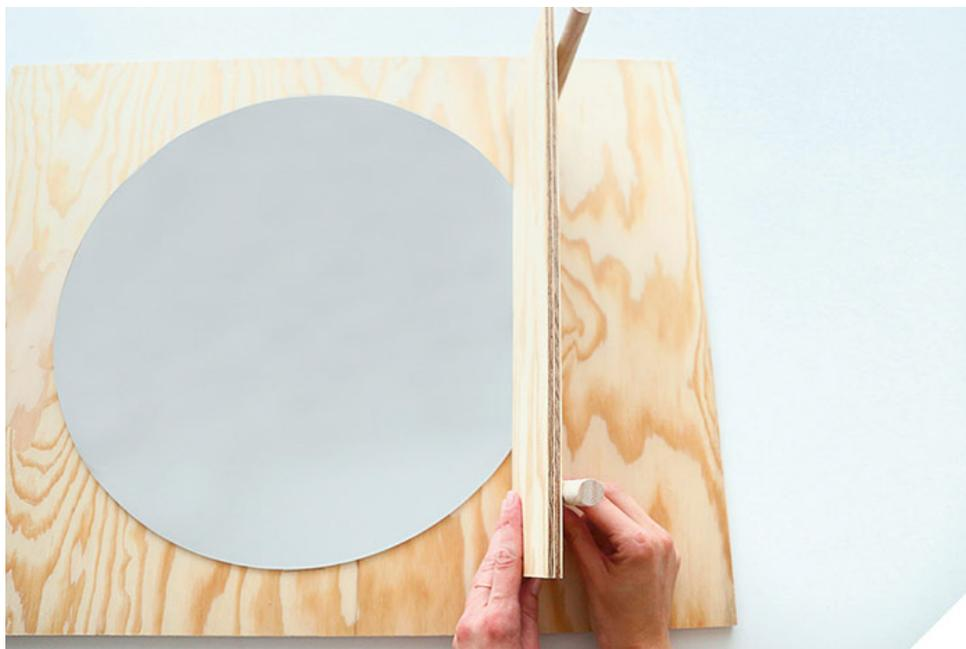
**6** Encollez une extrémité des tourillons et insérez-les dans leur trou. Passez au besoin un peu de papier de verre à l'intérieur des trous pour les élargir légèrement. Collez la planche dessus. Laissez sécher avec un serre-joint de chaque côté.
