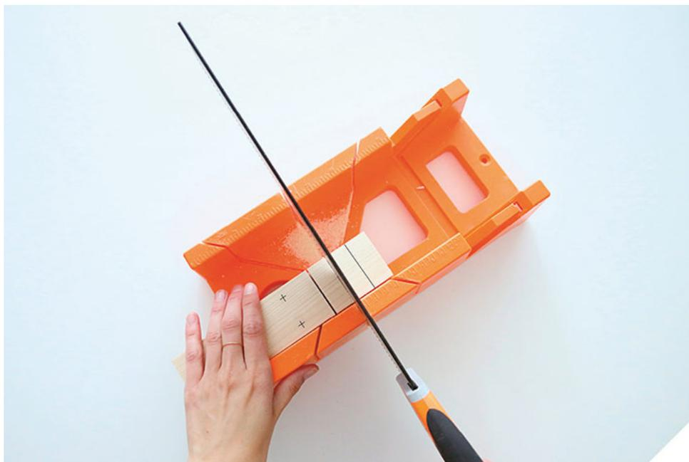
**3** Placez le tasseau dans la boîte à onglet. Sciez sur les 3 lignes de repère tracées à l'étape 1, sur 2 cm de profondeur, c'est-à-dire jusqu'au niveau des lignes tracées à l'étape 2.
