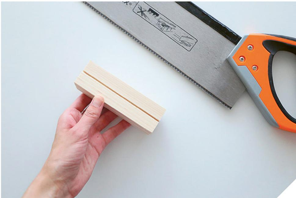
**4** Continuez l'entaille à la scie, jusqu'au repère fait aux extrémités, soit jusqu'à 0,5 cm de profondeur.
