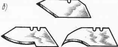
13. Нож-резак (а) со сменными резцами (б)
