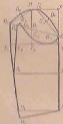
Рис. 107. Чертеж выкройки рукава.
