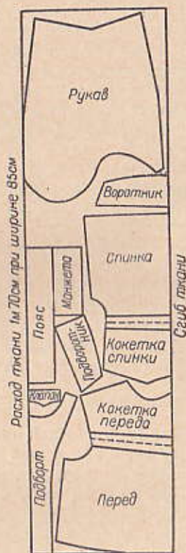
Рис. 159. Раскладка на ткани выкройки спортивной блузы.
