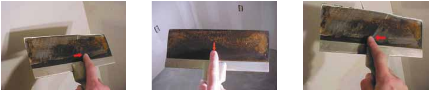
Фото 31. Способы удерживания шпателя при работе
