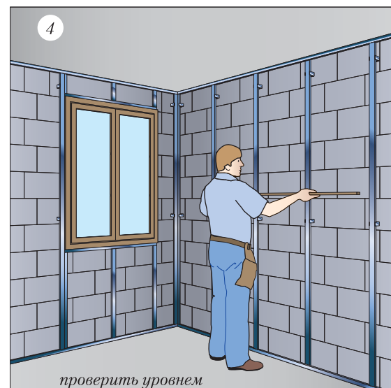
Рис. 23. Последовательность обшивки стен листами ГКЛ по металлическому каркасу (начало)
