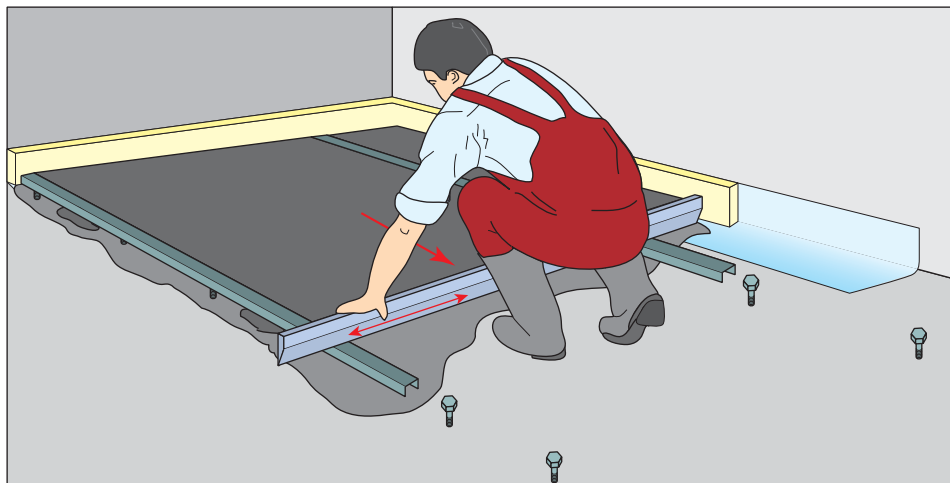
Рис. 33. Разравнивание стяжки правилом по маякам
