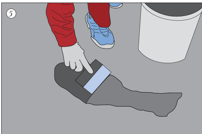
Защаклевать ремонтной смесью
