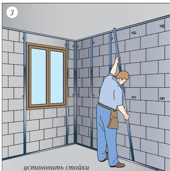
Рис. 23. Последовательность обшивки стен листами ГКЛ по металлическому каркасу (начало)
