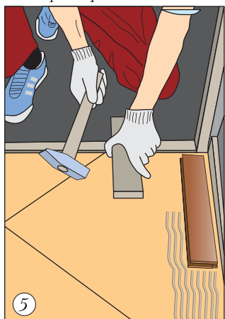
5 Паркетные клепки устанавливать вплотную к рейкам
