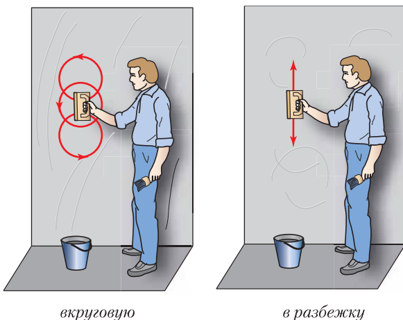
Рис. 11. Перетирка штукатурки
