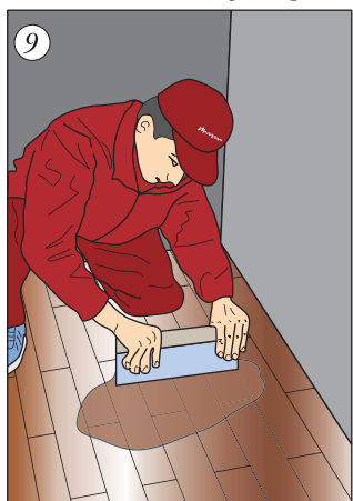
9 Зашпаклевать, загрунтовать и покрыть паркет лаком (в несколько слоев)
