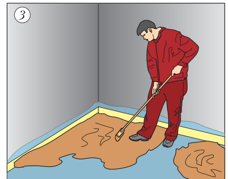
Уложите сухую засыпку по всей площади помещения
