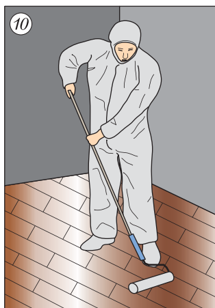
9 Зашпаклевать, загрунтовать и покрыть паркет лаком (в несколько слоев)
