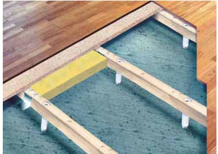
Фото 47. Изоляция от акустических шумов
