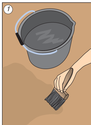
Смочить ДВП водой
