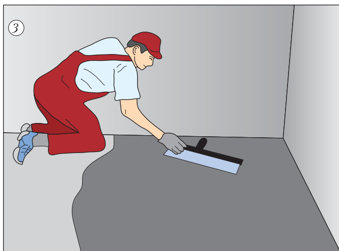
3 Растянуть стяжку гладилкой, правилом или шпателем, задавая толщину стяжки
