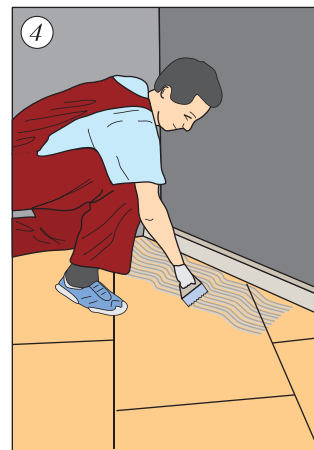
4 Установить вдоль стен рейки и нанести клей
