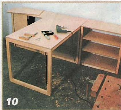
Чтобы внешняя торцовая кромка столешницы была заподлицо с опорной рамой, элементы жесткости (рейки) в этом месте должны быть на 33 мм короче длины столешницы. Раму со столешницей соединяют на клею и шурупах.
