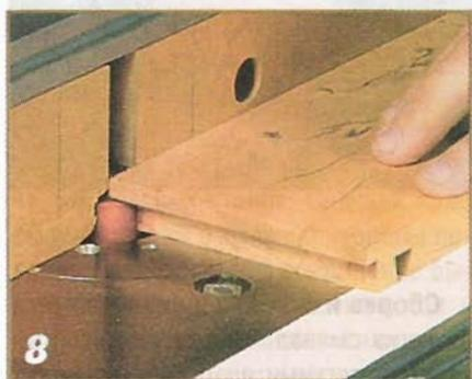
Четверть создает «губу». После выборки пазов и шипов «ласточкин хвост» и «сухой» сборки прямой фрезой на верхнем и боковых ребрах передней стенки выберите четверть. Получится 5-мм «губа»-выступ.
