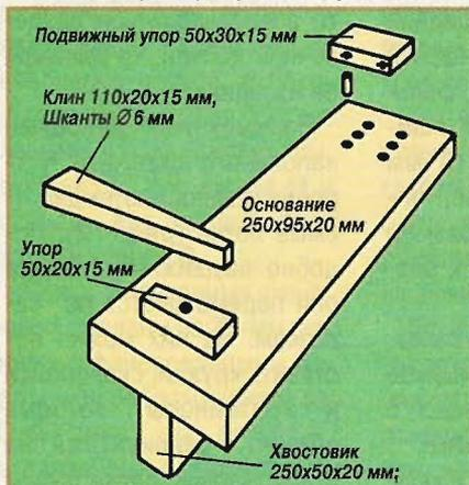
при приспособления, который зажимают в тисках, и упор крепят к основанию шурупами. Подвижный упор фиксируют на основании с помощью шкантов.
