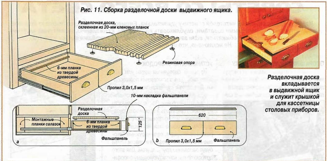
Рис. 11. Сборка разделочной доски выдвижного ящика.
