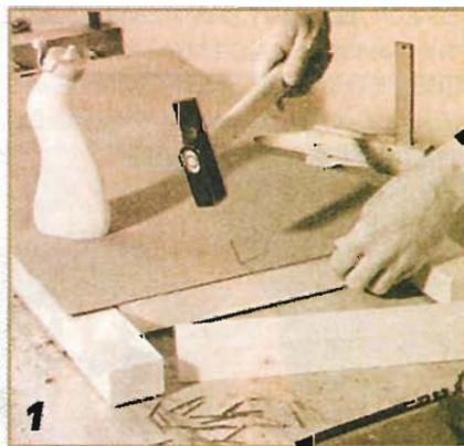
Сначала делают боковые стенки шкафа. Для этого рейку режут по длине на заготовки для вертикальных стоек боковых стенок. Ровно по кромкам их наклеивают на заранее раскроенные в размер элементы наружной обшивки из твердой ДВП. Дополнительно их прибивают гвоздями. Внизу между вертикальными стойками вклеивают горизонтальный элемент, а в середине, параллельно им — усиливающий брусок.
