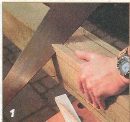
По размерам, указанным на рисунке, выпиливают стойки А. Верхние концы стоек опиливают по уклону крыши на 40 мм. Отметив на ребрах стоек концы фасок и сделав ограничительные запилы под углом 45°, размечают линии по ширине фаски (25 мм).
