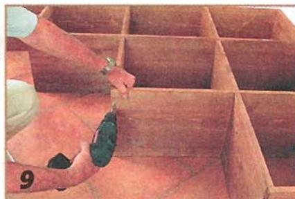
9 В процессе сухой сборки подгоняют детали, обеспечивая плотное, без зазоров соединение.
