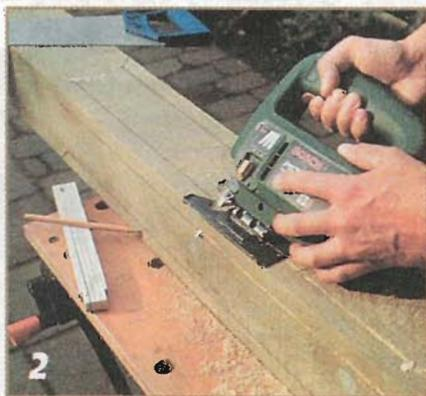
Фаски можно сделать, например, электролобзиком, наклонив его подошву, а затем зачистить шлифмашинкой.
