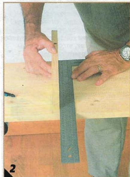
*При разметке деталей используйте столярный угольник, рейку-шаблон, равную по толщине раскраиваемому материалу, и учитывайте толщину линии разметки.*
