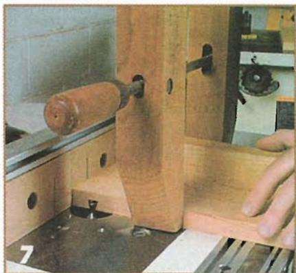
Левый паз фрезеруется справа налево. Если подавать заготовку справа налево, фреза прочно прижмет заготовку к линейке. Однако для гарантии ее лучше прижать к делительной головке.
