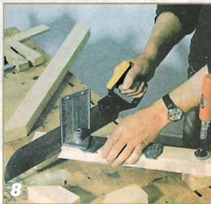
Опорную раму столешницы изготавливают из строганой рейки. Концы заготовок срезают «на ус», наносят клей на контактирующие поверхности и на шкантах  $\varnothing 8$  мм соединяют в раму. И в этом случае очень важно выдержать прямоугольность рамы.
