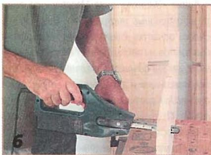
6 Для плотного прилегания деталей пазы тщательно подшлифовывают.
