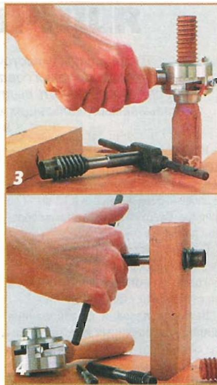
**Лучше всего подходит для изготовления резьбовых деталей граб, клен, бук и орех. При нарезании как внутренней, так и наружной резьбы режущие части инструментов следует предварительно смазать льняным маслом.**
