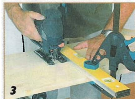
*Раскрой заготовок ведите с помощью направляющей линейки, надежно зафиксированной на рабочем столе.*
