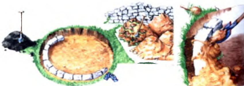
Сооружение сухой стенки на естественно уплотнённой почве. Камни засыпаются с внутренней стороны землей.
