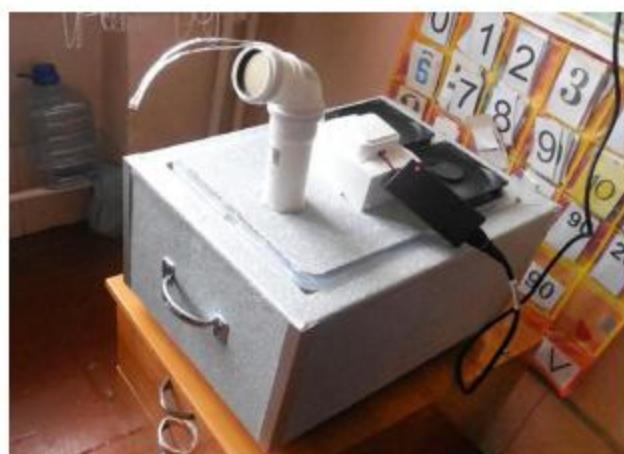
ли два отверстия d 120 мм. На одной стороне закрепили ламинат толщиной 8 мм и оклеили его фоамираном (**фото 4**). Обратную сторону крышки закрыли фольгированной подложкой. **5.** Саморезами зафиксировали на крышке два кулера 120x120 мм и вырезали еще одно отверстие d 50 мм под установку трубы для выхода охлажденного воздуха.
