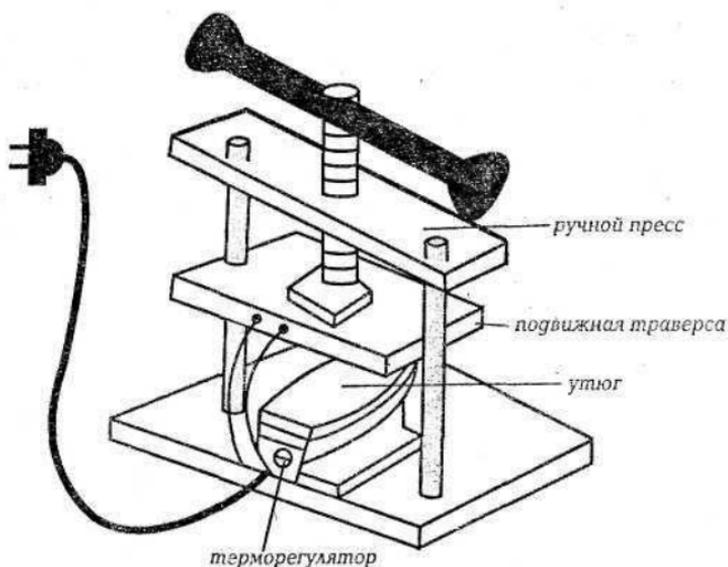
Рис. 4. Общий вид вулканизатора
