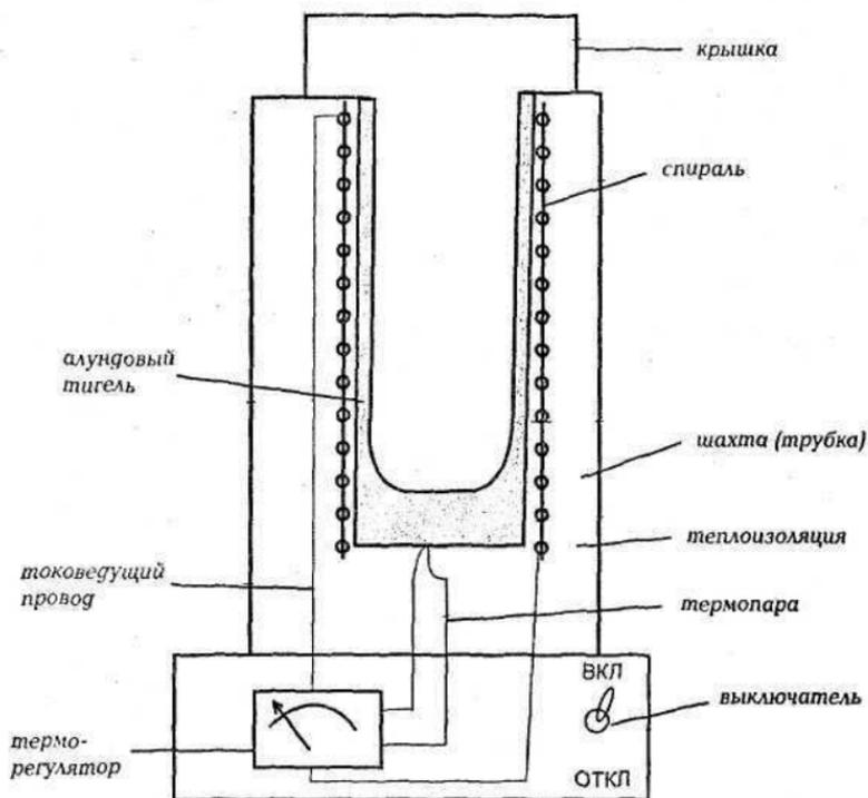
Рис. 1. Схема самодельной электрической плавильной печи
