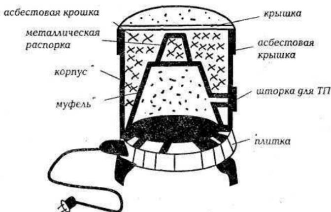
Рис. 3. Схема самодельной муфельной печи для небольших форм
