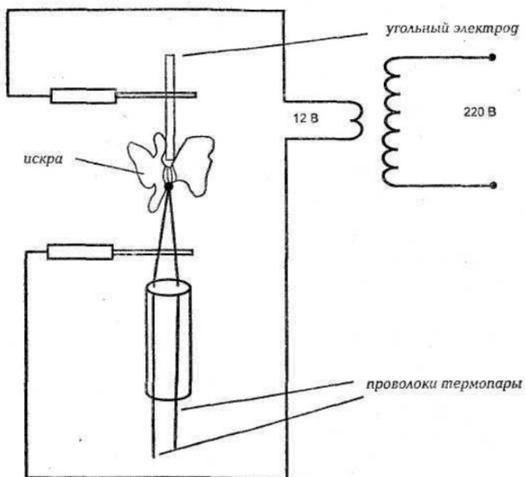
Рис. 11. Схема изготовления термопары
