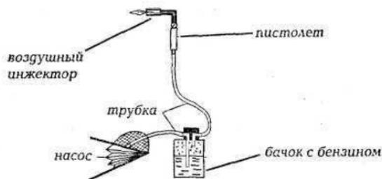
Рис. 9. Схема бензино-воздушной горелки
