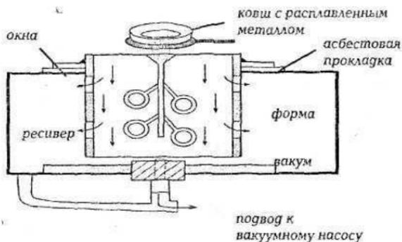
*Рис. 8. Схема вакуумного литья*
