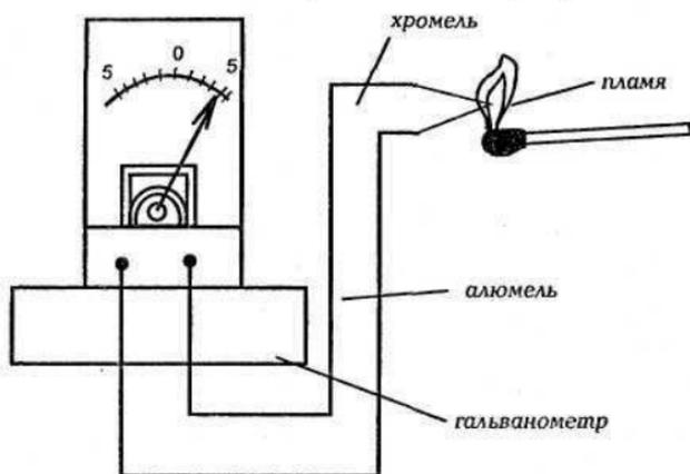
Рис. 10. Принцип работы термопары
