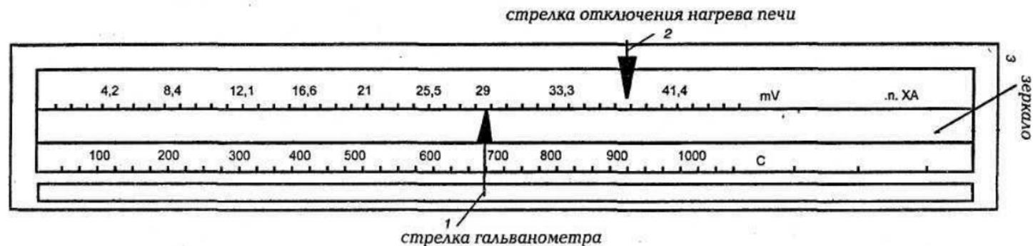
Рис. 13. Шкала гальванометра, отградуированная одновременно в мВ и в °С:
