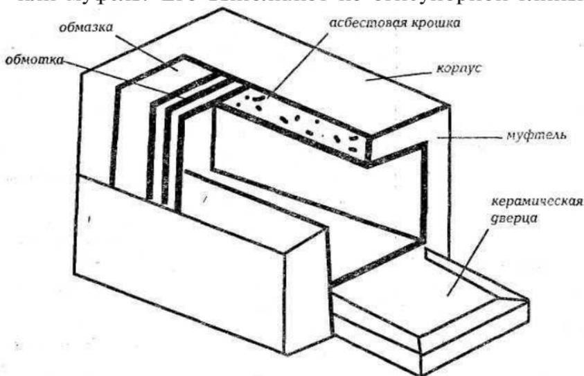
Рис. 2. Схема самодельной муфельной печи
