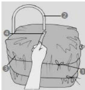
2 Положите верхнюю панель на резервуар и отметьте, где проходит вестовая труба через крышку резервуара. Сделайте разрез в панели до этой отметки.
