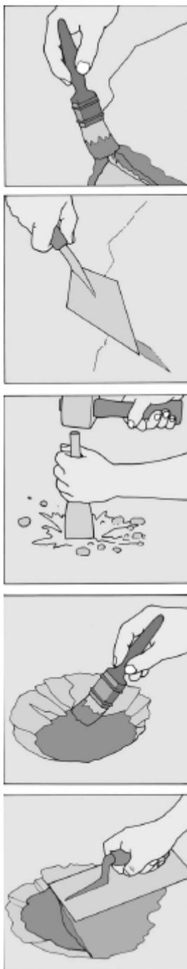
5 Когда он высохнет, заполните отверстие строительным раствором из песка и цемента, хорошо трамбуя его и выровняв его мастерком или теркой.
