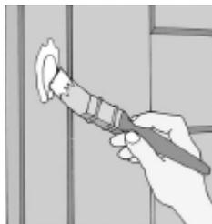
5 Оставьте его высыхать. Затем нанесите один или два слоя грунтовки поверх чистого дерева.
