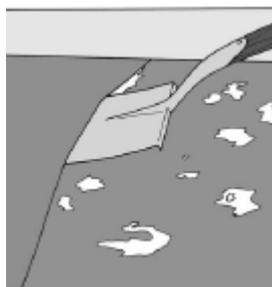
3 Если винил полностью приклеен, поднимите или оторвите угол или стык. Протолкните под него садовую лопату и поднимайте секцию за секцией.
