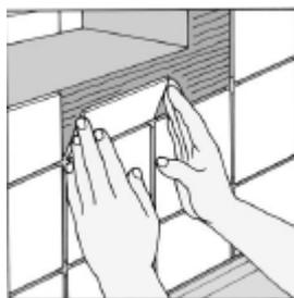
2 Используйте пилу для резки плитки, чтобы вырезать L-образные куски, которые подойдут к нижним углам проема.
