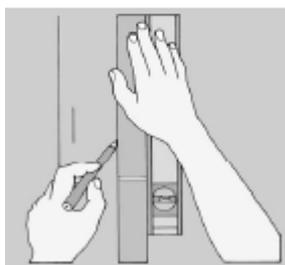
3 Передвиньте мерный шест вдоль на половину ширины плитки и сделайте новую отметку на стене. Она будет обозначать новую центральную линию облицовки.
