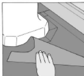
6 После того как вы все отрезали, приклейте двустороннюю ленту к полу по периметру всей комнаты и вокруг каждого препятствия. Положите винил и придавите его.
