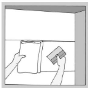
Подносите обои к стене складками и наклеивайте первую полосу на уровне потолка. Подрежьте их в углах с каждого конца. Затем наклейте следующие полосы ниже нее, оставляя между ними небольшой зазор. Подрежьте последнюю полосу по ширине прямо над плинтусом.
