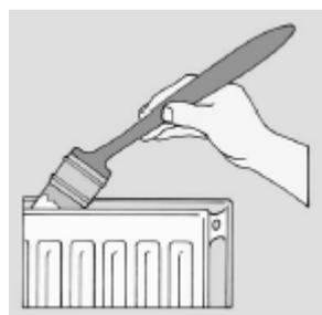
2 Покрасьте затем бороздки. Начинайте с одной стороны радиатора и сначала покрасьте углубленную часть, затем соседнюю углубленную часть, применяя вертикальные движения кистью.
