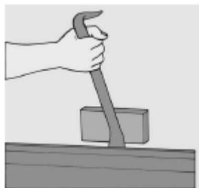
2 На стенах, покрытых деревянными панелями, плинтусы будут крепиться паркетными гвоздями. Вставляйте широкое зубило позади каждой секции и отделяйте ее.
