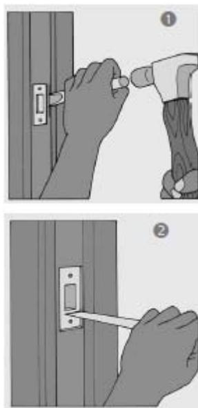
3 Чтобы поднять планку вверх или вниз, снимите ее и используйте зубило, чтобы отрезать верх или низ паза. Вы, вероятно, также должны будете расширить более глубокое отверстие в раме. Затем поставьте планку на место и проверьте дверь.
