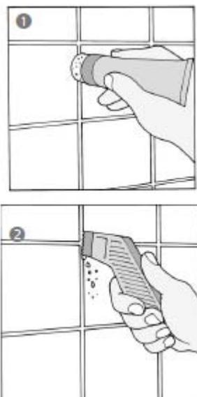
3 Если цементная поверхность гладкая, но грязная, используйте специальный инструмент для восстановления ее цвета. Он похож на шариковую ручку. Просто проводите им вдоль цементных линий.
