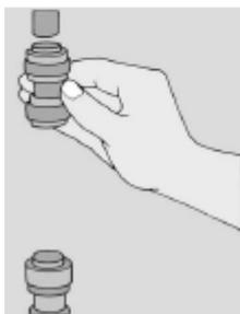
2 Купите две пластмассовых муфты с плотной посадкой и короткий кусок гофрированной медной трубы (часто она продается вместе с набором для починки труб). Наденьте фитинг на каждый отрезанный конец трубы.
