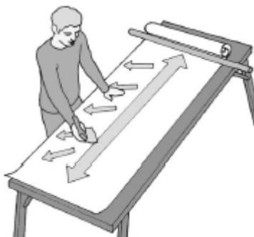
4 Когда вы покрыли клеем развернутую часть обоев, сложите складками проклеянный конец и подвиньте отрезок вниз по столу, чтобы вы смогли покрыть клеем остальную часть.
