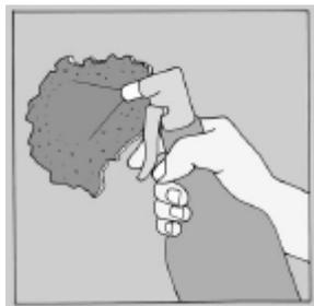
3 Заполните отверстие слоями примерно 12 мм толщиной, дав каждому затвердеть. Используйте кусок дерева, чтобы выровнять участок, затем отшлифуйте его движениями из стороны в сторону.
