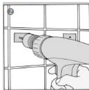
2 Приклейте липкую ленту поверх каждой отметки, чтобы предупредить скольжение сверла, и просверлите отверстия. Вставьте дюбели и винты в отделку.
