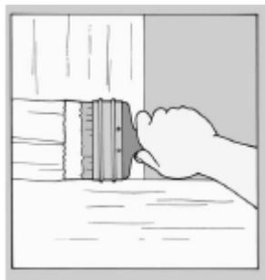
3 После завершения основной поверхности стены, используйте узкую кисточку для обработки кромок, до липкой ленты.
