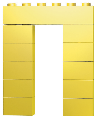
Рис. 1.18. Представьте, какой станет крохотная разница в точности изготовления, если умножить ее на количество слоев
