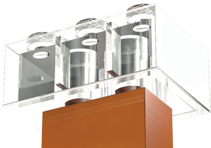
Рис. 1.21. Шипы вставляются в трубки, а не рядом с ними
