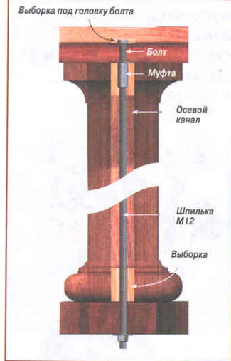
Рис. 7. Сборка столика. Дополнительную опору столешницы, ножку и основание прочно свинчивают с помощью болта М12, муфты и резьбовой шпильки.
