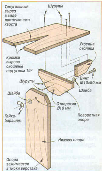
Рис. 1. Столик-подставка «ласточкин хвост» для выпиливания лобзиком.
