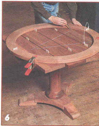
6 Разметка деталей центральной части крышки-столешницы. Во время разметки одинаковые зазоры фиксируют прокладками толщиной 5 мм.
