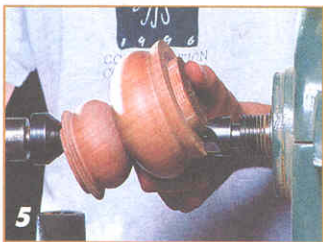
Маленький перекус. Сбрав крышку и корпус, устанавливаю шкатулку между центрами по второй оси.
