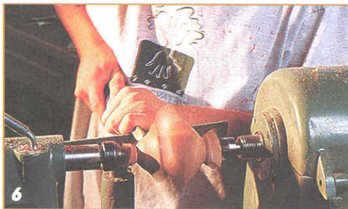
Точение эксцентрической формы. Сбрасываю обороты и, прочно прижав резец к поддержке, на крышке и корпусе протачиваю плавный S-образный профиль.
