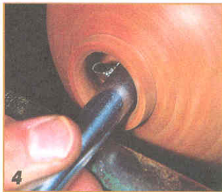
Выборка полости в корпусе. Проточив отверстие, выбираю полости короткой полукруглой желобчатой стамеской. Выступы в полости срезаю Г-образным шабером.
