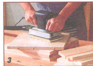
3 Вклеив в гнезда шканты, обе пласти детали обрабатывают виброшлифовальной машинкой сначала с грубой шкуркой, а затем — с тонкой.
