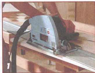
1 Детали полки из клееного щита выкраивают ручной дисковой пилой, оснащенной направляющей.
