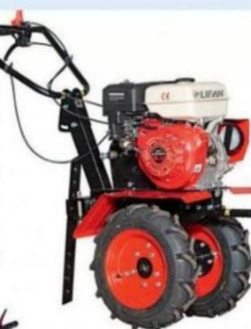
**Тяжелые (профессиональные).** У техники редуктор шестеренчатого типа, полноценная коробка передач, мощность до 16 л.с. Машины идеальны для интенсивных нагрузок, поэтому их и используют в фермерских и агротехнических хозяйствах.
