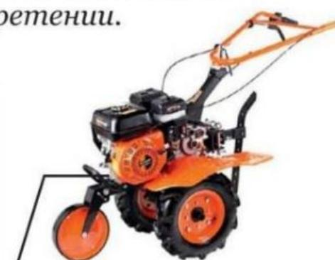
**Легкие (универсальные).** У техники этого класса весом до 80 кг мощный двигатель, а ширина фрез составляет 50-90 см. Модели в основном оборудованы четырехтактными моторами, которые отличаются большим КПД и интенсивным сгоранием топлива. Всё это делает агрегат более производительным. Но, увы, он не для узких борозд.
