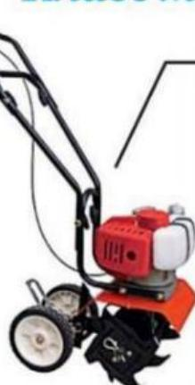
**Сверхлегкие.** Подойдут для участков в пределах 20-40 соток. У этой техники небольшая ширина захвата обработки (до 30 см), поэтому с ней можно пройти по узким бороздам и междуурядьям. В большинстве своем такие модели оснащают двухтактными двигателями. Работают они на смеси бензина и специального масла.
