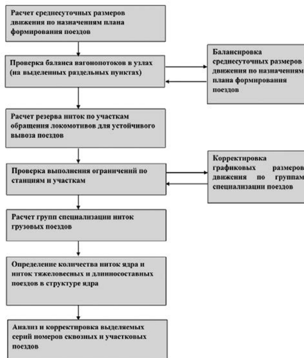
Рис. 1. Порядок расчета проектов заданий на разработку графика движения грузовых поездов, включая автоматизированный расчет таблиц графиковых поездопотоков для составления графика движения
